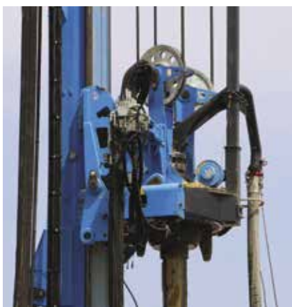
↑ PARTICOLARE DELLA ROTARY MONTATA SULLA PERFORATRICE SR-125 HIT
